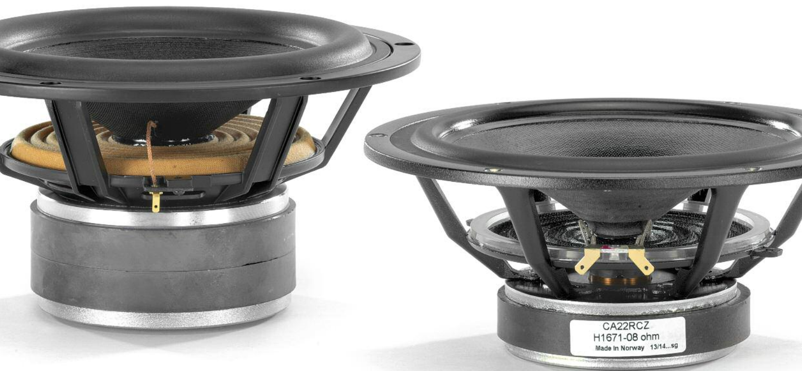
Die Chassis unter dem Hochtöner: 22-cm-Downfire-Subwoofer und ein modifizierter Papiertreiber von SEAS mit breitbandigem Auftritt (80 bis 2500 Hz)
